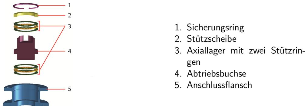
Abbildung 4.1: Abtriebsbuchse A
