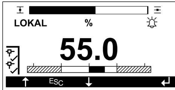
Abbildung 6.2: Grundbildschirm des Displays nach Systemstart
