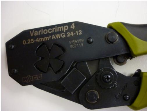
Abbildung 9: Aderendhülsenpresszange WAGO Variocrimp 4
