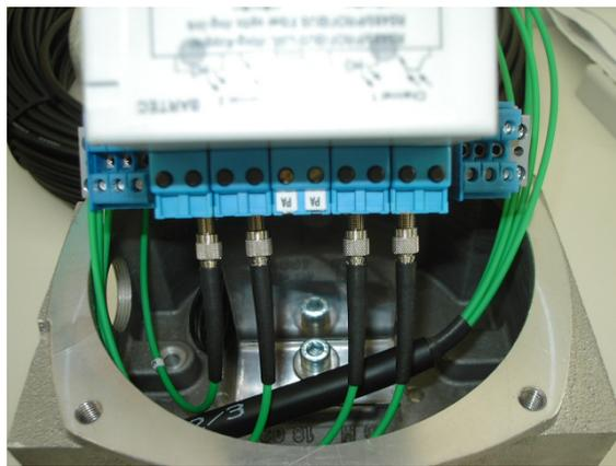
Abbildung 12: LWL Anschluss im Klemmenkasten – Detailansicht Geräteklammer
