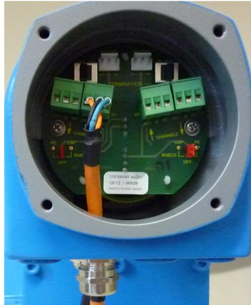
Abbildung 7: Busanschluss-Platine
