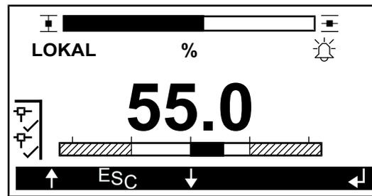
Die Vor-Ort-Bedienung erfolgt mithilfe von vier Bedientasten, die entweder als mechanisch bewegliche Federtaster oder aber als verdeckte Magnettaster ausgeführt sind (siehe [Ortssteuerstelle](#) [▶ 21]). Magnettaster erfordern zur Bedienung einen speziellen Magnetbedienstift als separates Zubehör.
