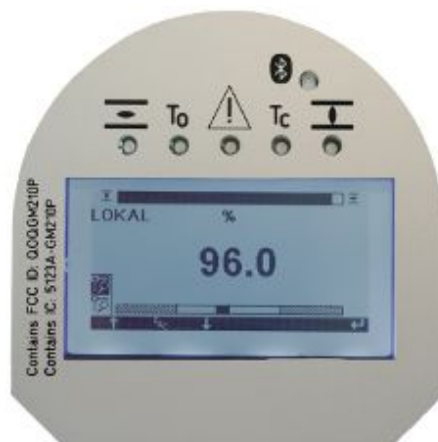
Bild 16: Display und Anzeigeelemente der lokalen Ortssteuerstelle
