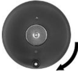
⇒ Antriebswelle (Armatur) dreht im Uhrzeigersinn in Richtung ZU.
