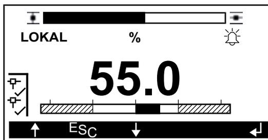
Die Vor-Ort-Bedienung erfolgt mithilfe von vier Bedientasten, die entweder als mechanisch bewegliche Federtaster oder aber als verdeckte Magnettaster ausgeführt sind (siehe [Ortssteuerstelle](#) [▶ 20]). Magnettaster erfordern zur Bedienung einen speziellen Magnetbedienstift als separates Zubehör.
