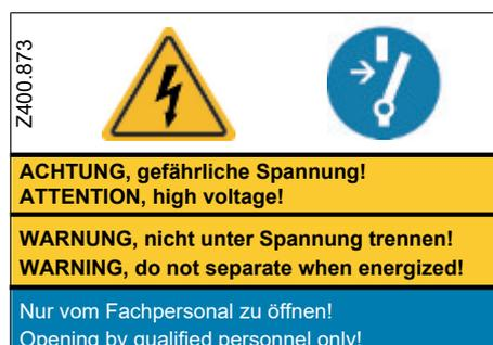
**Bild 30: Aufkleber bei ATEX Ausführung**
