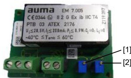
Bild 22: Elektronischer Stellungsgeber B3 (EM7.005) in Explosionsschutzausführung
