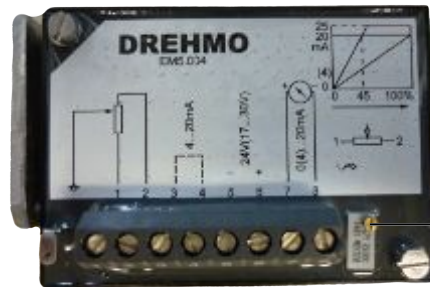
Bild 21: Elektronischer Stellungsgeber EM5.004
